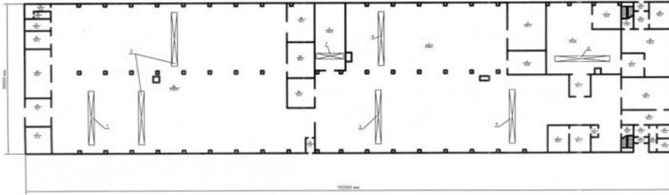
1. Мостовой кран грузоподъемностью 10 т.
